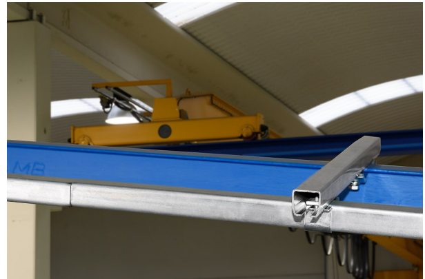
PLETINAS SOLDADAS A LA VIGA
