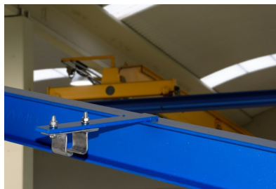
PLETINAS SOLDADAS A LA VIGA
