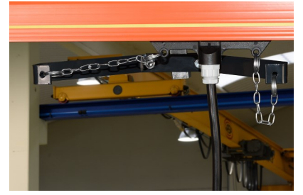
Monter le bras de guidage BA-4 fixer aux chaînes du chariot aligné avec le centre de la gaine. Le bras doit rester au dessous de la gaine à environ 30/50mm.
