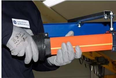
Fermer le bouchon à l'extrémité de la ligne pour éviter les contacts électriques indésirables.
