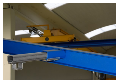
BRAS SOUDEES A LA POUTRE
