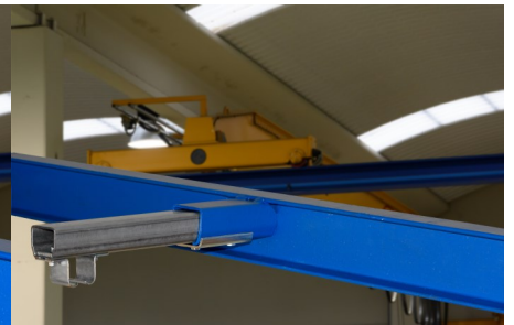
BRAS SOUDES A LA POUTRE
